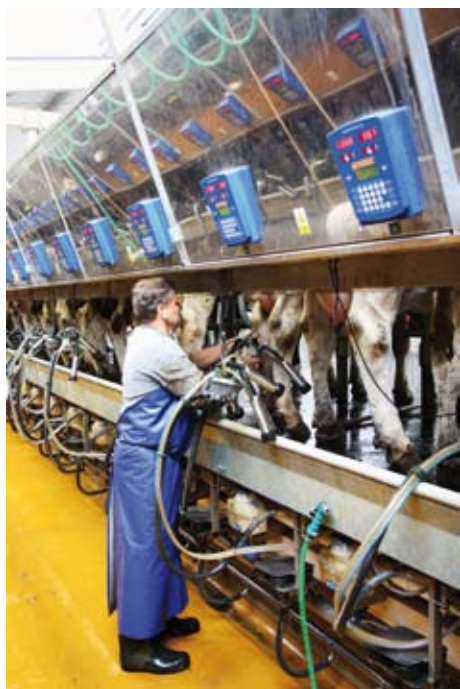
Novostavba paralelní dojírny značky FARMTEC 2 x 1 x 20 stání s identifikací dojnic, měřením nádoje a měrné vodivosti mléka na farmě Petrovice-Bystřice. Data z dojírny a systému sledování a vyhodnocování pohybové aktivity zvířat jsou zpracovávána zootechnickým programem FARMSOFT.
