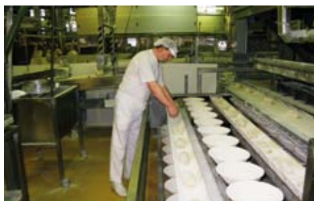
6.50 Mistr kontroluje kvalitu tvarování, které provádí stroj. Správným nastavením určuje konečný vzhled výrobku.
